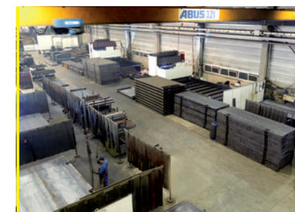
линия по производству стенок крепей
